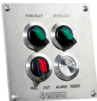
Die Fernbedienung erfordert einen Montageausschnitt von 60 mm x 60 mm oder 80 mm Lochkreis; die Grundplatte hat die Größe 95 mm x 95 mm und wird mit den beiliegenden kleinen Holzscrews an den Ecken befestigt.
