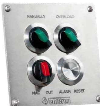
La télécommande nécessite une découpe de montage de 60 mm x 60 mm ou un cercle de boulonnage de 80 mm ; la plaque de base a une taille de 95 mm x 95 mm et est fixée aux coins avec les petites vis à bois incluses. Notez la profondeur d'installation nécessaire de 45 mm. La télécommande peut également être montée dans une boîte pour parois de 80 mm :
